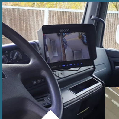
Installation de l'écran dans le poste de pilotage
